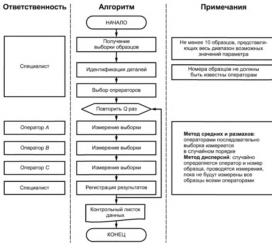
Рисунок 10 — Порядок сбора данных об измерительном процессе для оценивания его сходимости и воспроизводимости
