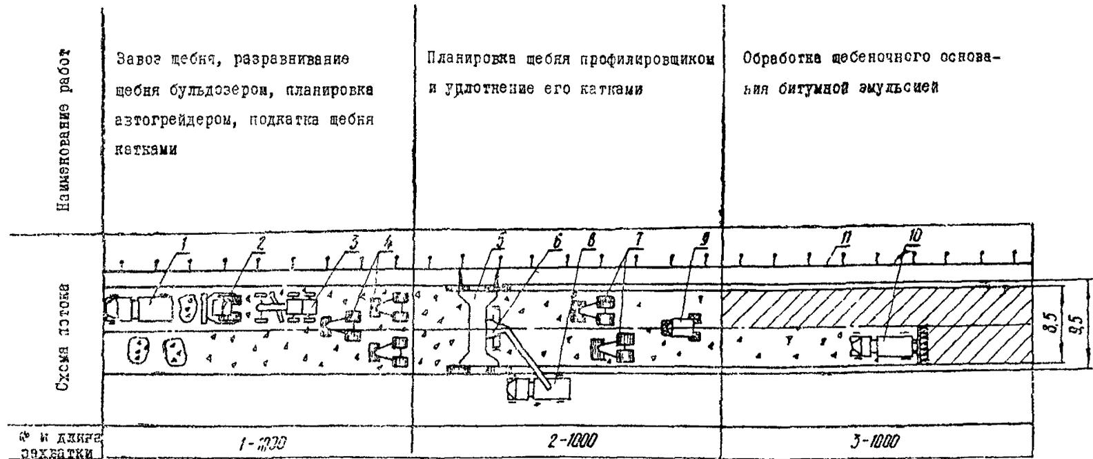
Рис. 2. Технологическая схема погода по устройству щебеночного основания:
