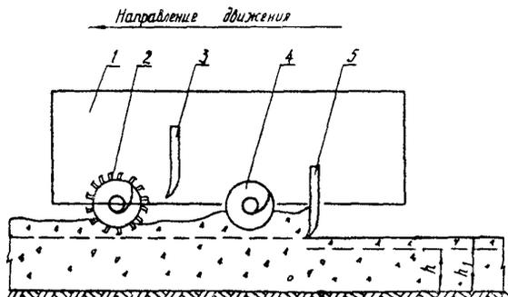
Рис 3 Положение рабочих органов профилировщика при планировке щебня
