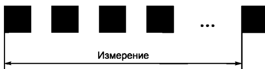
Рисунок 34 — Пример измерения шага пикселей
