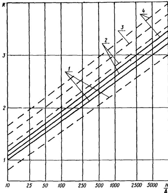
Рис.1. График изменения коэффициента  $K$ : (---) – для откосов канав прямоугольного поперечного сечения; (—) – для дна тех же канав; 1; 2; 3 и 4 при  $\frac{b}{H}$  соответственно равном 0,5; 2,5; 5 и 10
