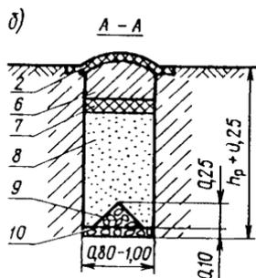
Рис.2. Схема устройства откосного дренажа: а - продольный разрез дренажа; б - поперечный разрез дренажа; 1 - лоток; 2 - укрепление поверхности откоса; 3 - глинистый грунт; 4 - слой водоносного грунта; 5 - фильтр из крупнообломочного материала; 6 - засыпка глинистым грунтом; 7 - водонепроницаемая прослойка; 8 - дренирующий грунт (средний или крупный песок); 9 - глухая дрена из щебня; 10 - слой щебня, втрамбованного в дно траншеи;  $h_p$  - расчетная глубина промерзания грунта
