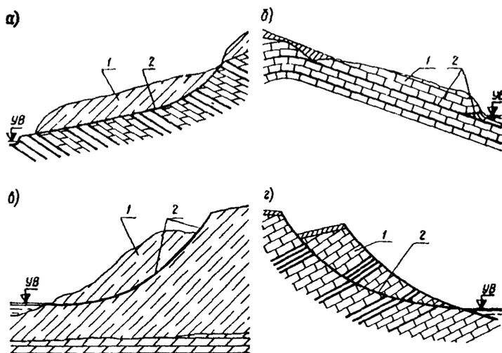
Рис. 2. Схемы образования оползней: а - контактный оползень I типа; б - структурный оползень I типа; в - консистентный оползень II типа; г - скальвающий оползень II типа; 1 - оползневой массив; 2 - поверхность скольжения
