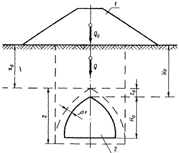
Рис. 1. Расчетная схема карстовой
