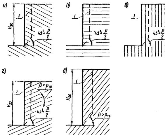
Рис.1. Расчетные схемы вертикальных откосов: а, б, в, г - благоприятное расположение плоскостей ослабления; д - неблагоприятное; I - контур вероятной поверхности обрушения
