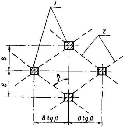
Рис. 3. Расчетная схема размещения свай в плане: 1 - сваи; 2 - линии вероятного скола снежного пласта.
