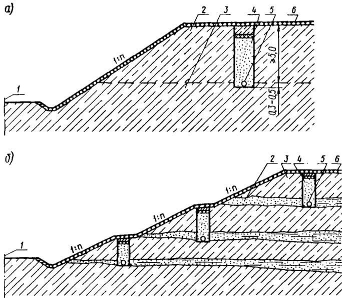
Рис.5. Схема устройства ограждающего дренажа: а - глубокого; б - системы дренажей; 1 - ось полотна; 2 - водоносный слой грунта; 3 - водоупорный слой грунта; 4 - дренаж; 5 - дренажная труба; 6 - укрепление откоса
