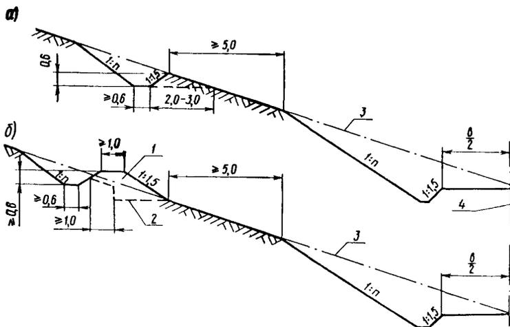
Рис. 9. Поперечные профили нагорных канав: а - заглубленных в грунт естественного сложения; б - частично заглубленных; 1 - валик из местного грунта; 2 - уступы в основании валика; 3 - поверхность косогора до устройства выемки; 4 - ось проектируемого полотна
