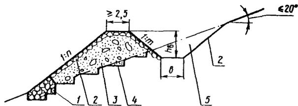
Рис. 38. Схема устройства улавливающего рва на косягоре крутизной до 20°: 1 - упор из каменной кладки; 2 - укрепление откоса; 3 - вал из местного грунта; 4 - уступы в основании вала; 5 - ров
