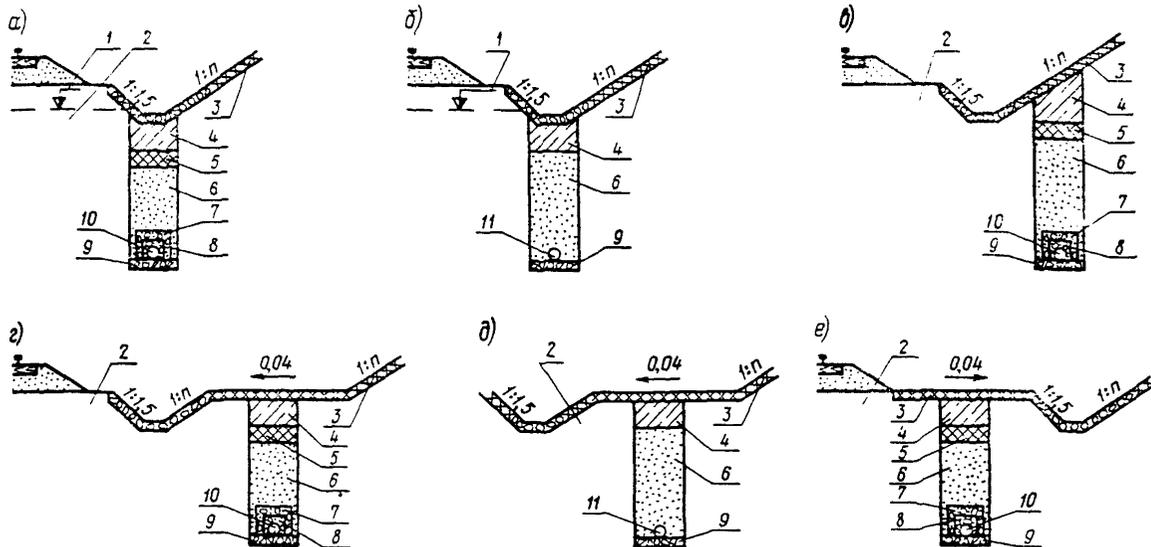
Рис.7. Поперечный разрез дренажа:
