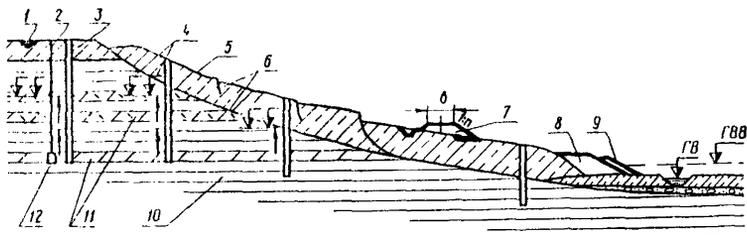
Рис. 24. Схема комплексного размещения противооползневых устройств: 1 - нагорная канава; 2 - скважина вертикальной дренажной завесы; 3 - разведочная скважина; 4 - установленный уровень напорных подземных вод; 5 - оползневой массив; 6 - поверхности скольжения оползневой массы; 7 - проектируемое земляное полотно; 8 - контрбанкет; 9 - укрепление подтопленного откоса; 10 - скальная водонепроницаемая порода; 11 - трещиноватая водоносная скальная порода; 12 - штольня
