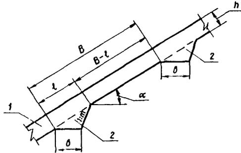
Рис.4. Расчетная схема размещения террас: 1 - снежный пласт; 2 - террасы
