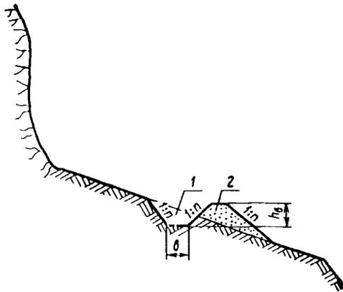
Рис. 37. Схема устройства улавливающего рва с валом в пределах косягора: 1 - ров; 2 - вал;  $h_b$  - глубина рва с валом
