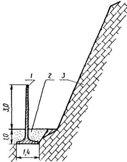
Рис. 4Г. Схема размещения барьерной улавливающей стены: 1 - стена; 2 - местный грунт; 3 - легко выветривающаяся скальная порода
