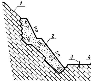
Рис.29. Схема устройства контрфорса: 1 - неустойчивый скальный массив; 2 - контрфорс; 3 - ось пути; 4 - проектируемое земляное полотно
