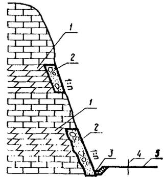
Рис.28. Облицовочные стены: 1 - легковыветривающиеся скальные породы; 2 - облицовочная стена; 3 - лоток; 4 - ось пути; 5 - проектируемое земляное полотно
