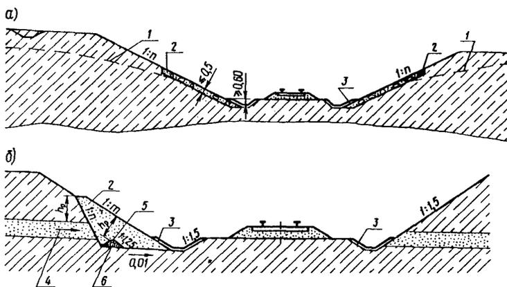
Рис.3. Способы осушения грунта в откосах:
