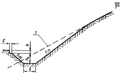
Рис. 5. Расчетная схема улавливающей траншеи: I – естественная поверхность склона;  $b, c, h, h_0, m, n$  – расчетные параметры
