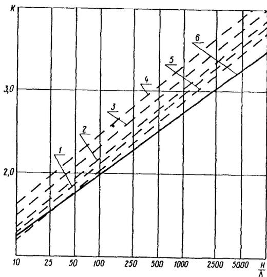
Рис.2. График изменения значений коэффициента  $K$ : 1; 2; 3 и 4 - для откоса крутизной 1:1 при  $\frac{H}{b}$  соответственно равном 0,5; 1,0; 2,5 и 5,0; 5 - для откоса крутизной 1:2,5 при  $\frac{H}{b}$  равном 0,5; 6 - для дна.
