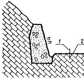
Рис.26. Подпорная стена: 1 - ось пути; 2 - проектируемое земляное полотно
