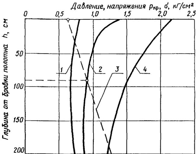
Рис. I. Кривые распределения по глубине нормальных напряжений в грунтах основания: 1; 2; 4 - при давлении под шпалой, равном соответственно 2, 4 и 6 кг/см<sup>2</sup>; 3 - прямая изменения бытового давления  $\bar{p}_{кр}$  от веса грунта при  $C=0,15$  кг/см<sup>2</sup>;  $\psi = 10^6$  (к примеру расчета)
