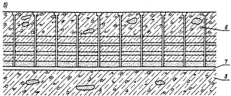
Рис. 6. Схема применения штольни для осушения откоса выемки:
