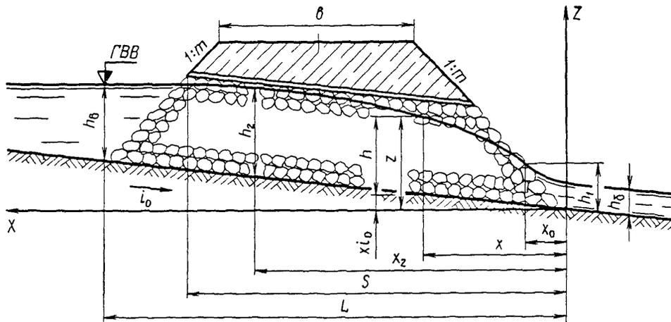
Рис. 2. Схема к гидравлическому расчету фильтрующих насыпей
