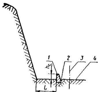
Рис.34.Схема устройства путевой улавливающей полки с барьерной стенкой:  $L$  - ширина полки, назначаемая по расчету;  $h_c$  - высота барьерной стенки, назначаемая по расчету; 1 - стенка; 2 - лоток; 3 - ось пути; 4 - проектируемое земляное полотно
