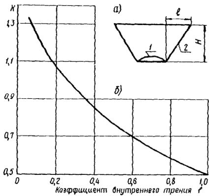
Рис. 2. Расчетная схема карстового провала: а - разрез провала; б - график для определения коэффициента  $K$ ; 1 - карстовая полость; 2 - расчетная плоскость обрушения;  $H$ ,  $l$  - расчетные параметры призмы обрушения
