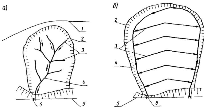
Рис. 2I. Схемы размещения водоотводных канав в пределах оползневого массива: а - "елочное"; б - параллельное; I - нагорная (ограждающая) канава; 2 - граница оползневого массива; 3 - канавы-собиратели; 4 - магистральная водоотводная канава; 5 - ось пути; 6 - водопропускное сооружение
