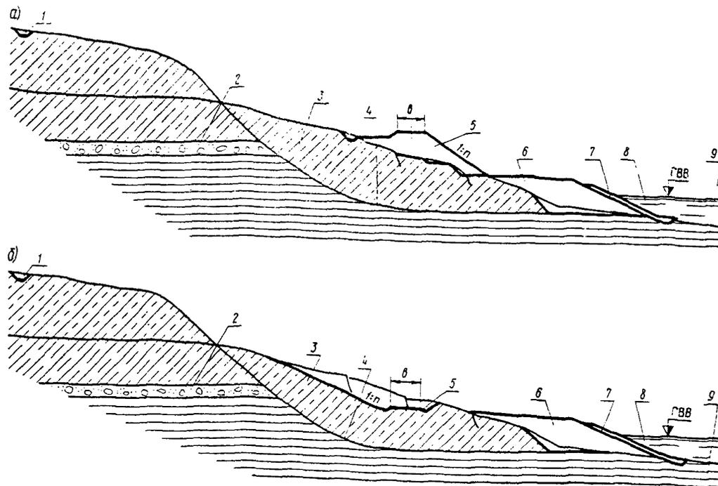
Рис.16. Схема размещения земельного полотна в средней части оползневой массы и противооползневых устройств: а - насыпь; б - выемка; 1 - нагорная (водоотводная) канава; 2 - водоносный слой; 3 - оползневой массив; 4 - вероятная поверхность скольжения оползневой массы; 5 - проектируемое земляное полотно; 6 - контрбанкет; 7 - укрепление откоса; 8 - водоток (водоём); 9 - скальная порода
