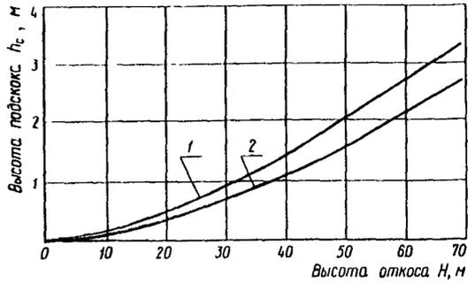
Рис.2. График для определения высоты подскока камней: 1 - для железных дорог I и II категорий; 2 - для железных дорог III - V категорий и автомобильных дорог
