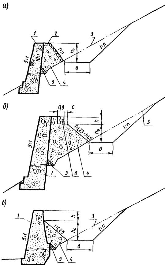
Рис. 42. Схемы улавливающих устройств: а - при расчетных скоростях движения камней до 20 м/сек; б, в - то же свыше 20 м/сек; 1 - стена; 2 - укрепление поверхности откоса; 3 - поверхность косогора до возведения улавливающих устройств; 4 - амортизирующая застенная засыпка; 5 - застенный дренаж; 6 - стенка из сухой кладки;  $h_0$  - высота застенной засыпки;  $h$  - высота стенки-ограничителя;  $b$  - ширина по дну улавливающей траншеи
