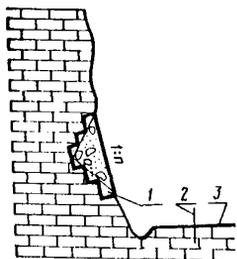
Рис. 30. Схема устройства пломбы:
