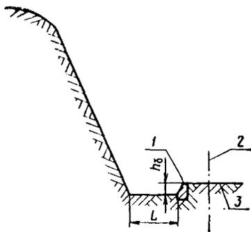
Рис.35.Схема устройства путевой улавливающей полки с бордюрной стенкой:  $L$  - ширина полки, назначаемая по расчету;  $h_б$  - высота бордюрной стенки, назначаемая по расчету; 1 - стенка; 2 - ось пути; 3 - проектируемое земляное полотно
