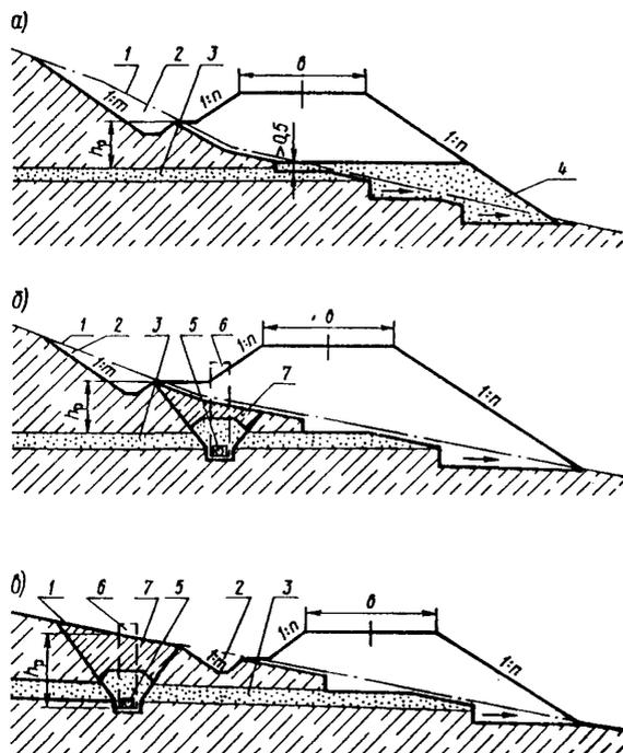
Рис. II. Поперечные профили насыпей с дренажными устройствами в местах выхода грунтовых вод:
