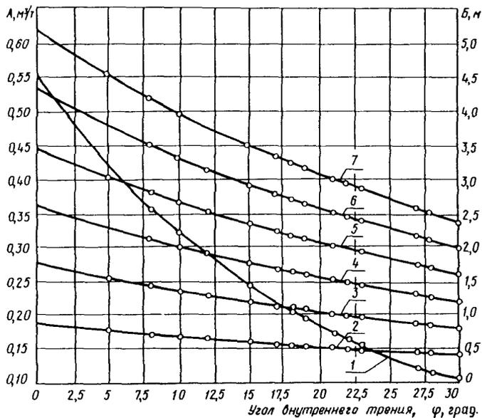
Рис. 2. Кривые зависимости параметров А и В от прочностных характеристик грунта:  $I - A = f(\varphi)$ ; 2, 3, 4, 5, 6, 7 - кривые зависимости параметра В от  $\varphi$  при С, равном соответственно 0,5; 1,0; 1,5; 2,0; 2,5; 3,0 т/м<sup>2</sup>
