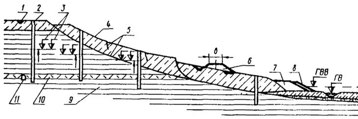
Рис. 23. Схема размещения противооползневых устройств: I — нагорная канава; 2 — скважины; 3 — напорный уровень подземных вод; 4 — оползневой массив; 5 — поверхности скольжения оползневого массива; 6 — проектируемое земляное полотно; 7 — контрбанкет; 8 — укрепление подтопляемого откоса; 9 — коренная горная порода (водоупорная); 10 — трещиноватая водоносная скальная порода; 11 — штольня
