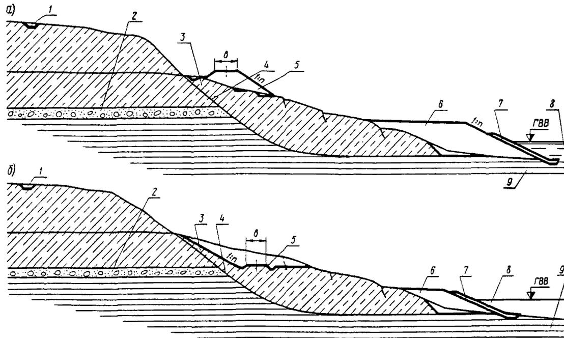
Рис.15. Схема размещения земельного полотна в головной части оползневого массива и противооползневых устройств: а - насыпь; б - выемка; I - нагорная (водоотводная) канава; 2 - водоносный слой; 3 - оползневой массив; 4 - вероятная поверхность скольжения оползневого массива; 5 - проектируемое земляное полотно; 6 - контрбанкет с размерами, назначаемыми по данным расчетов; 7 - укрепление откоса; 8 - водоток (водоём); 9 - скальная порода
