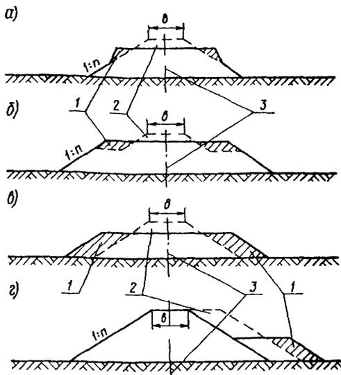
Рис.48. Поперечные профили насыпей из дренирующих грунтов с размещением запасов грунта: а - на откосах; б - на берме; в - в нижней части полотна; г - то же в случае присыпки к существующему полотну; 1 - запас грунта; 2 - контуры части насыпи, возводимой механическими средствами из запасов; 3 - ось пути; в - ширина земляного полотна
