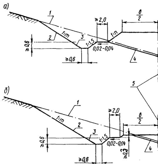
Рис. 10. Поперечные профили водоотводных канав, размещаемых в непосредственной близости от земляного полотна: а – углубленная канава у насыпи; б – углубленный кювет в полувыемке; 1 – поверхность откоса до устройства земляного полотна; 2 – укрепление откоса; 3 – укрепление канавы (кювета); 4 – растительно-дерновый покров, подлежащий удалению; 5 – ось проектируемого полотна.
