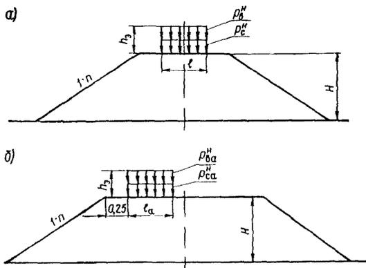
Рис. I. Расчетная схема действия временной нагрузки на основную площадку земляного полотна дорог: а - железных; б - автомобильных
