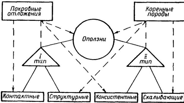
Рис. 1. Классификационная схема оползней
