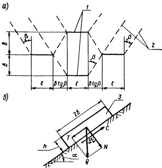
Рис.1. Расчетные схемы удерживающих сооружений: а - размещение в плане; б - в разрезе; 1 - удерживающие сооружения; 2 - линии вероятного склона снежного пласта; 3 - снежный пласт между двумя секциями сооружения
