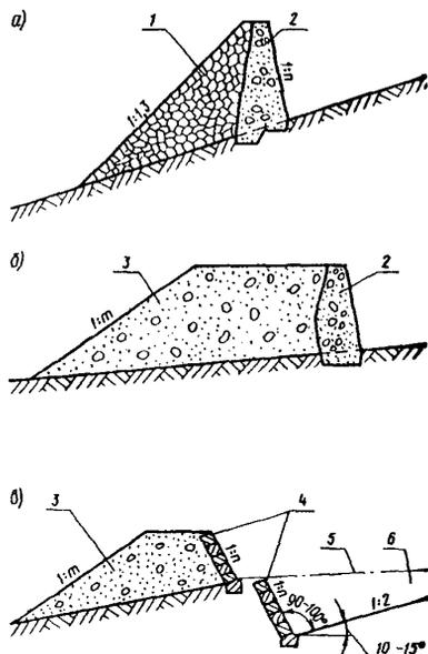
Рис. 45. Схема сооружений для задержания лавин: а - стена; б - дамба со стеной; в - дамба со рвом; 1 - каменная наброска; 2 - стена; 3 - дамба из местного грунта; 4 - стены из бетонных блоков; 5 - поверхность склона до устройства рва; 6 - ров
