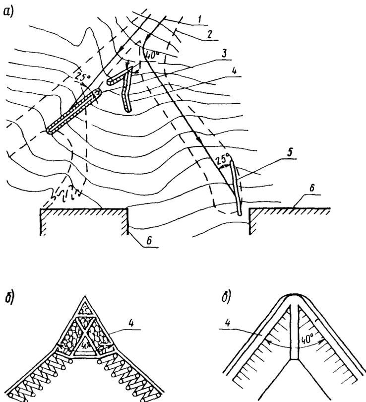
Рис. 44. Схемы устройств для отвода снежных лавин: а - план расположения сооружений; б - план ряжевого лавинореза; в - план лавинореза из камня: 1 - направления движения лавины; 2 - контуры конусов выноса; 3 - направляющая дамба; 4 - лавинорез; 5 - направляющая стена; 6 - защищаемые объекты
