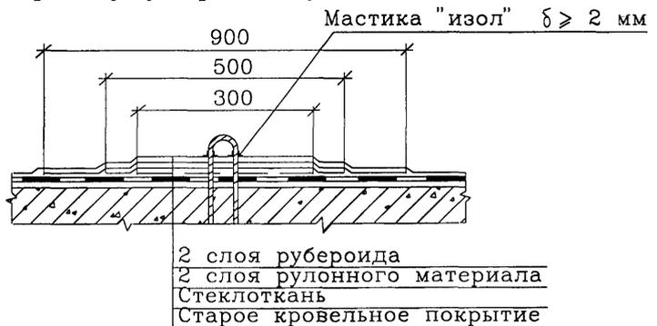
Рисунок 2 – Устройство мест примыканий
