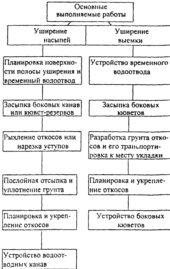
Рис 3. Последовательность работ при уширении земляного полотна
