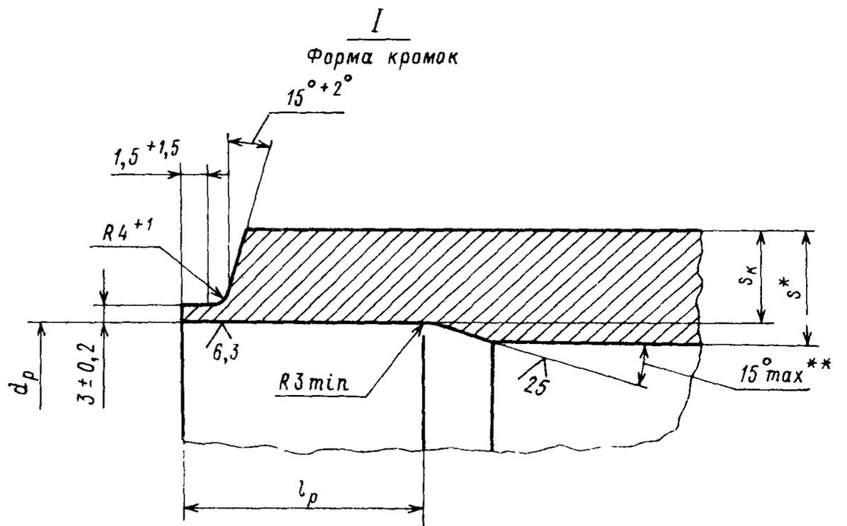
\*\* Для исполнений 01, 06, 07, 10, 14—21 допускается угол выхода не более  $27^\circ$ .
