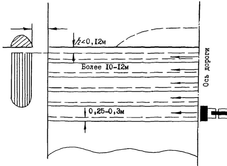
Поперечная схема срезки растительного слоя грунта.
