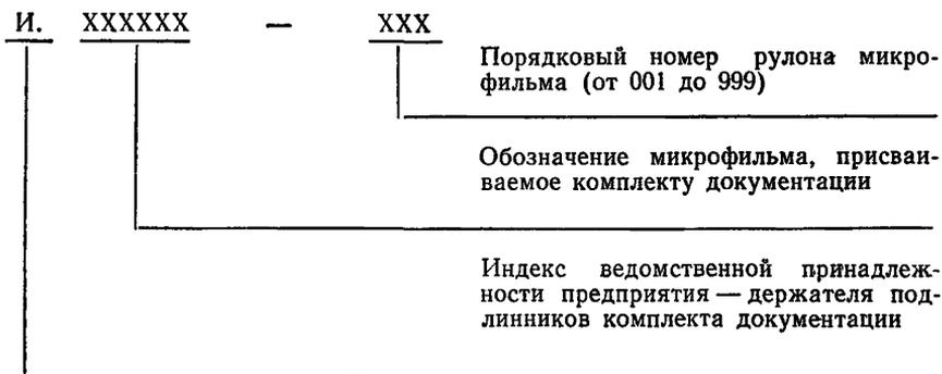
\* Допускается присваивать отдельные обозначения микрофильмам конструкторской и технологической документации или нескольким комплектам документации на изделия одного министерства (ведомства), когда их микрофильмируют на одном рулоне.
