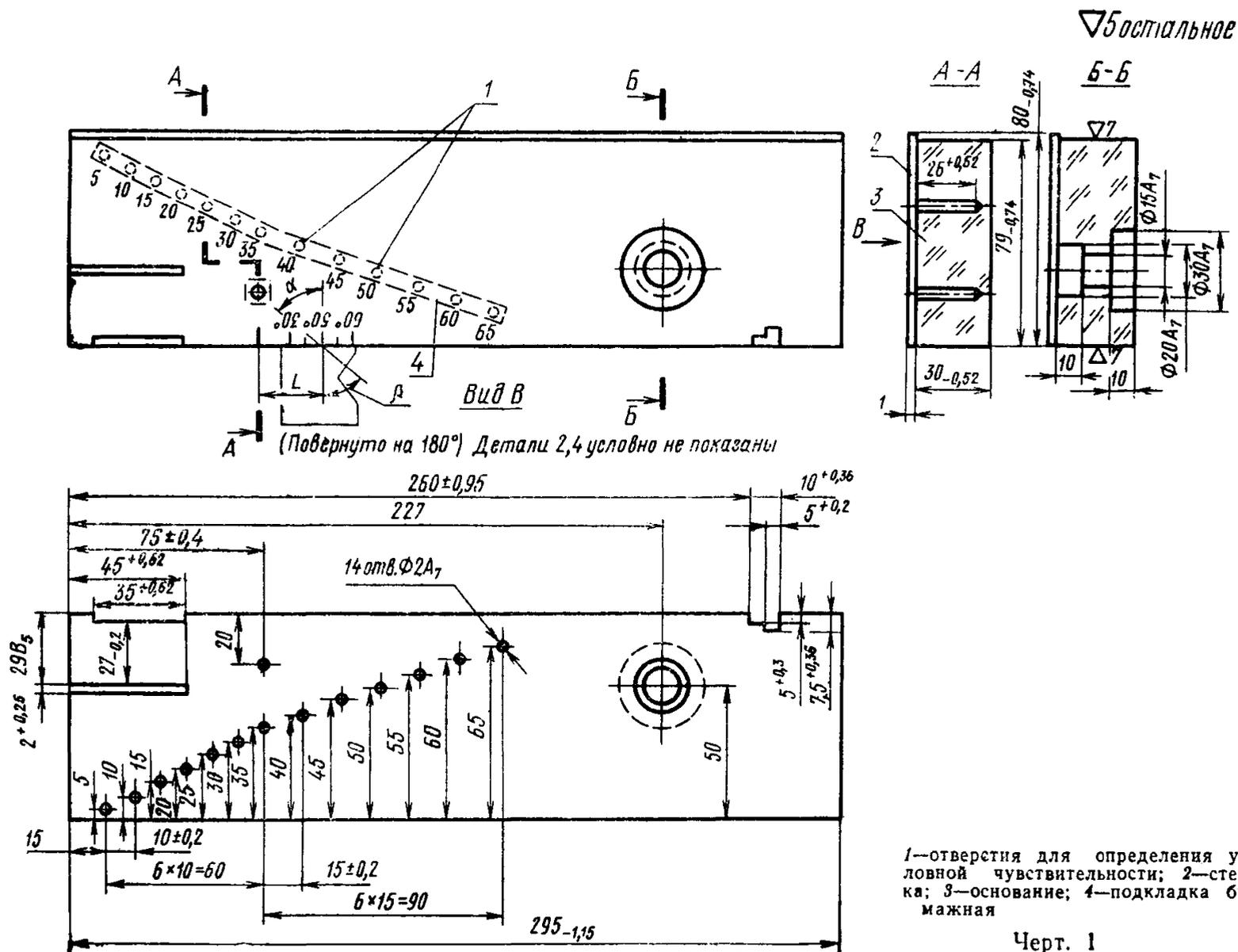
ности работы глубиномера дефектоскопа и угла призмы искателя  $\beta$ .
