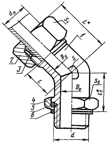
1—угольник по ГОСТ 21861—78; 2—накидная гайка по ГОСТ 23353—78; 3—врезающееся кольцо по ГОСТ 23354—78; 4—установочная гайка по ГОСТ 15802—76; 5—прокладка исполнения 2 по ГОСТ 23358—78; 6—прокладка исполнения 1 по ГОСТ 23358—78
