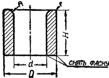
Пример обозначения втулки с  $d=5$  мм,  $D=9$  мм и  $H=12$  мм:
