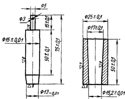
а) два валика из стали марки 45 или близких к ней по ГОСТ 1050—60. Размеры валика указаны на чертеже. Для удобства проведения испытания валики изготавливают одинакового веса. Цилиндрическая часть валика отделена от конической бороздкой глубиной не более 0,01 мм. Поверхность валика шлифована до класса  $\nabla 8$  по ГОСТ 2789—59;
