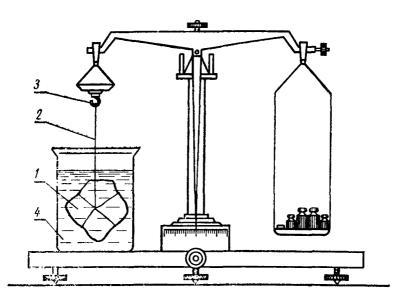
Образец, взвешенный в воздухе с точностью до 0,01 г, поднимают за проволоку, подводят под него сосуд с дистиллированной водой 4, осторожно опускают его в воду, проверяя одновременно, не касается ли он стенок сосуда, погружен ли он полностью в воду и не остались ли на нем прилипшие пузырьки воздуха, подлежащие удалению, вновь затем взвешивают с точностью до 0,01 г при полном его погружении в воду.
