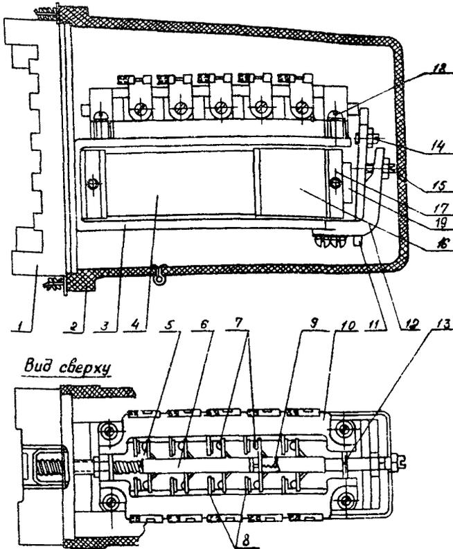
Рис. 4. Общий вид реле РП-25I:
