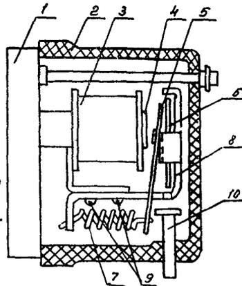
Рис. 13. Общий вид реле ЭС-4I:
