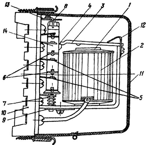
Рис. 2. Общий вид реле РП-23, РП-232, РП-233:
