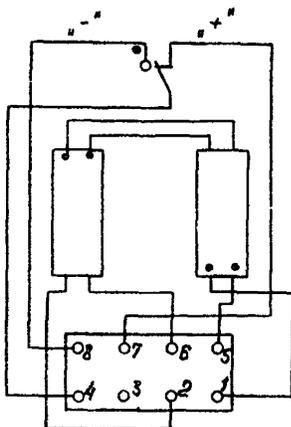
Рис.26. Схема внутренних соединений поляризованного реле ТРМ-Т
