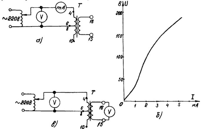
Рис. 27. Схемы проверки трансформатора реле РИС-Э2М, РИС-Э2М-0,2:
