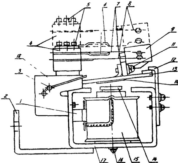
Рис. 6. Общий вид реле РПУ-1-О10:
