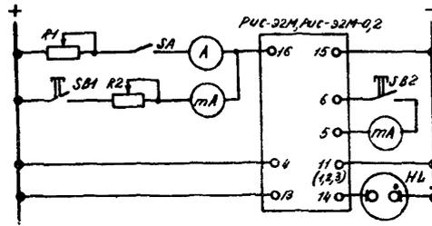
Рис. 23. Схема настройки реле РИС-32М,
