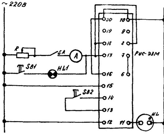
Рис.24. Схема настройки реле РИС-33М
