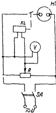
Рис. 16. Схема проверки напряжения срабатывания и возврата реле
