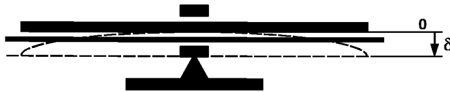
Рисунок 1 — Схема испытания модельных образцов гипсовых повязок прямоугольной формы по консольному бесконтактному методу
