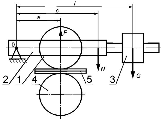
$l$  — прижимной ролик; 2 — прижимная рама; 3 — дополнительный груз; 4 — ведущий ролик;  $F$  — сила прижима ленты;  $N$ ,  $G$  — соответственно сила веса прижимной рамы 2 и груза 3;  $a$ ,  $c$ ,  $l$  — плечи соответствующих сил; 5 — элементарная проба
