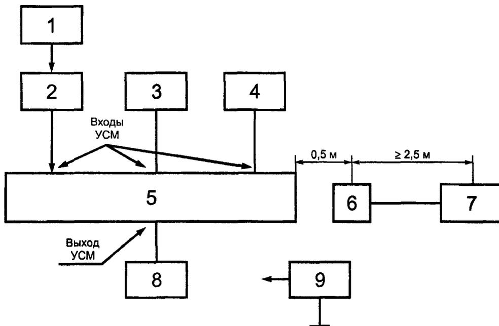
1 — генератор сигналов ВЧ; 2 — согласованный коаксиальный переход; 3, 4, 8 — экранированные согласованные нагрузки; 5 — УСМ; 6 — измерительная антенна; 7 — измеритель напряженности ЭМП; 9 — милливольтметр ВЧ
