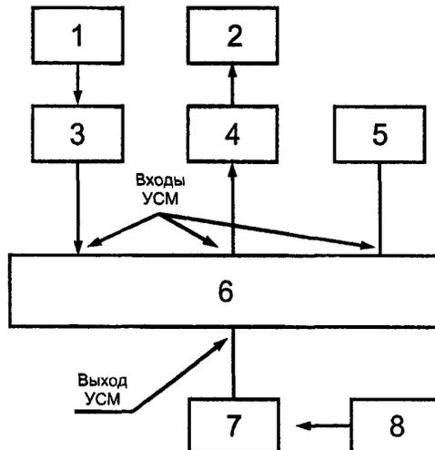
1 — генератор сигналов ВЧ; 2 — селективный микровольтметр; 3, 4 — согласованные коаксиальные переходы; 6 — УСМ; 5, 7 — согласованные экранированные нагрузки; 8 — милливольтметр ВЧ
