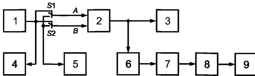
1 — генератор сигналов НЧ; 2 — передатчик; 3 — эквивалент антенны; 4 — милливольтметр НЧ; 5 — измерительный экранированный резистор сопротивлением  $(600 \pm 30)$  Ом; 6 — элемент связи; 7 — девиометр; 8 — декодер стереосигнала; 9 — ИНИ или анализатор спектра НЧ; S1, S2 — переключатели
