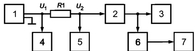
1 — генератор сигналов НЧ; 2 — передатчик; 3 — эквивалент антенны; 4, 5 — милливольтметры НЧ; 6 — элемент связи; 7 — девиометр; R1 — резистор сопротивлением  $(2 \pm 0,1)$  кОм
