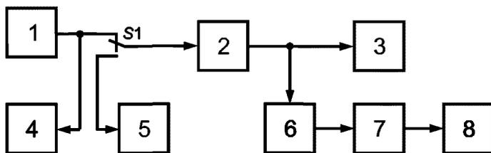
1 — генератор сигналов НЧ; 2 — передатчик; 3 — эквивалент антенны; 4 — милливольтметр НЧ; 5 — измерительный экранированный резистор сопротивлением  $(600 \pm 30)$  Ом; 6 — элемент связи; 7 — девиометр; 8 — псофометр или милливольтметр НЧ; S1 — переключатель
