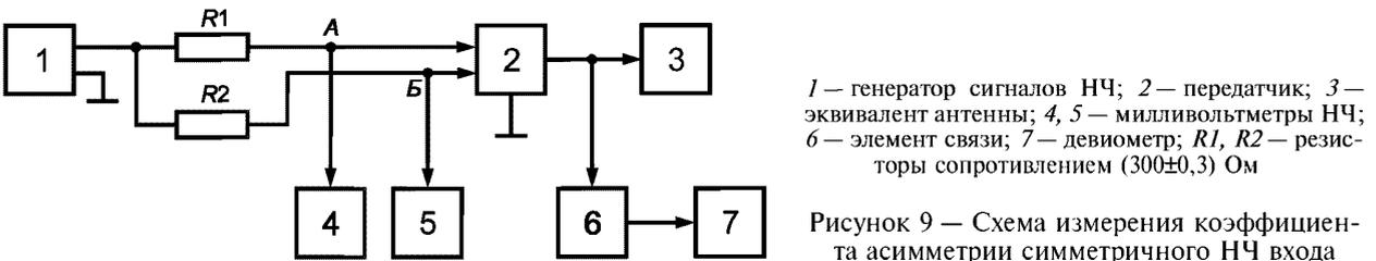
На вход передатчика подают синфазный сигнал частотой 1000 Гц и напряжением 0,775 В, установленным по одному из милливольтметров.
