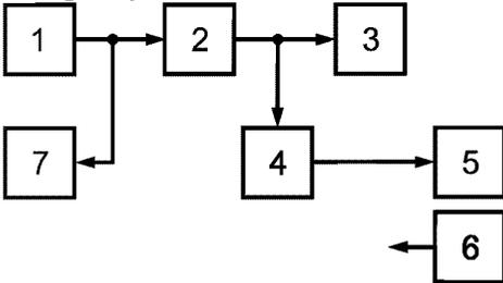
1 — генератор сигналов НЧ; 2 — передатчик; 3 — эквивалент антенны; 4 — элемент связи; 5 — модулометр; 6 — девиометр; 7 — милливольтметр НЧ
