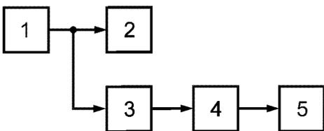
1 — передатчик; 2 — эквивалент антенны; 3 — элемент связи; 4 — девиометр; 5 — частотомер
