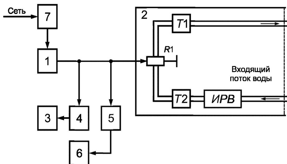
1 — передатчик; 2 — эквивалент антенны;  $R1$  — водоохлаждаемый согласованный резистор;  $T1$ ,  $T2$  — термометры воды на выходе и входе системы охлаждения;  $ИРВ$  — измеритель расхода воды; 3 — частотомер; 4 — элемент связи; 5 — аттенюатор; 6 — вольтметр ВЧ; 7 — ваттварметр
