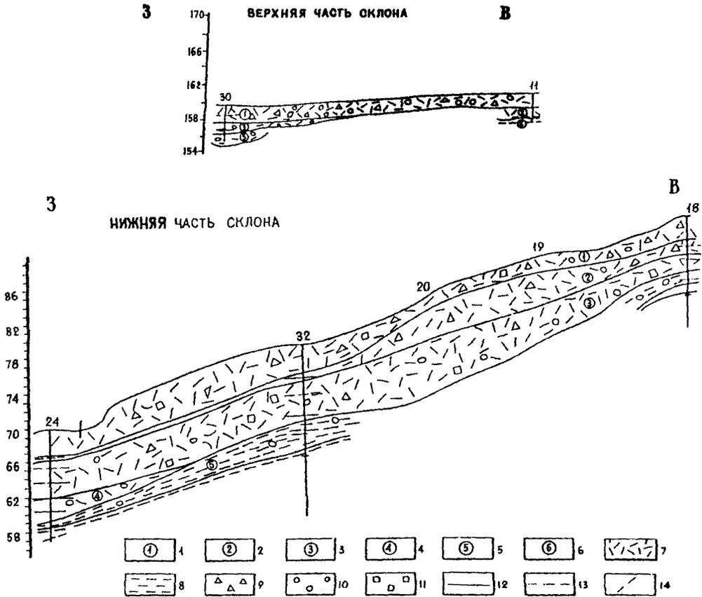
Рис.7. Геологический разрез оползневого склона "финбанк" г.Хоста
