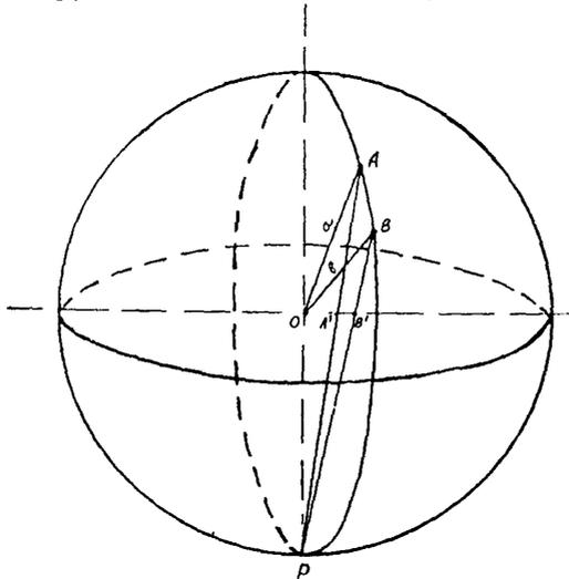
Рис.3. Принцип стереографической проекции
