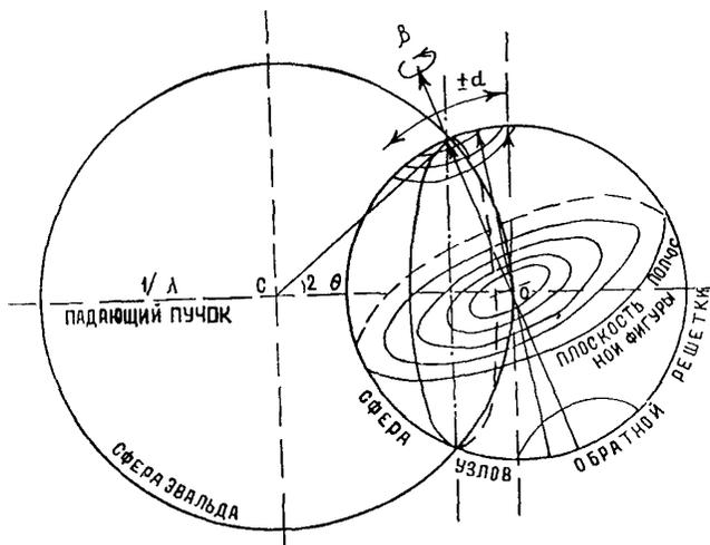
Рис.4. Геометрия съемки текстуры дифрактометрическим методом ("метод на отражение")
