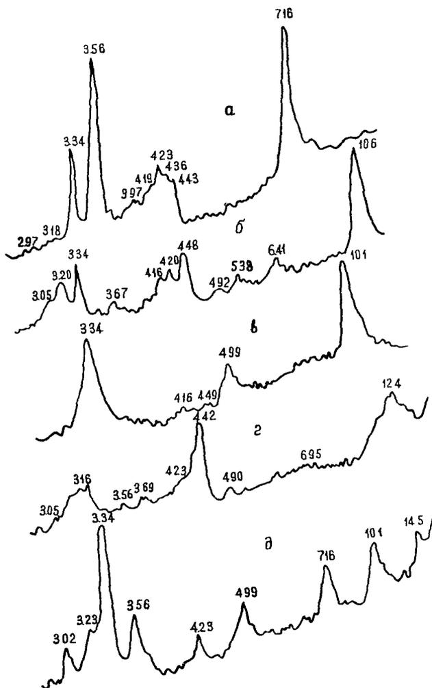
Рис.2. Дифрактограммы малоугловых областей мономинеральных образцов. Условия съемки:  $2\theta$   $\lambda_{Cu}$ ,  $\lambda_{Ni}$  - фильтр; 35 кв, 10 ма; щели, I, 0,5; 0,25x8 мм; 1000имп/сек; I град/мин, RC -IY; а) каолинит положский; б) палыгорскит черкасский; в) иллит; г)  $Ni$ -аскангель; д) полиминеральный образец № 2681 г.Хоста (каолинит+гидрослюда+хлорит+кварц+кальцит+полевоы шпат)
