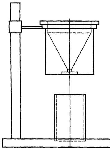
Рисунок 2 — Схема калиброванной воронки и стойки
