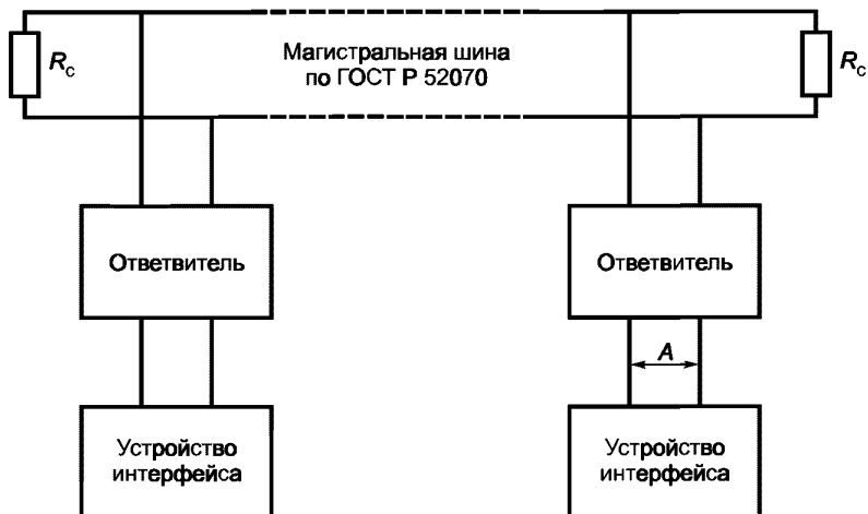
Рисунок 1 — Измерение активного сопротивления ответвителя с трансформаторной связью
