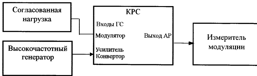
Рисунок 7.6 — Структурная схема для определения отношения сигнала изображения к фоновой помехе
