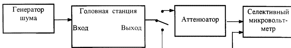
Рисунок 7.10 — Структурная схема для измерения коэффициента шума
