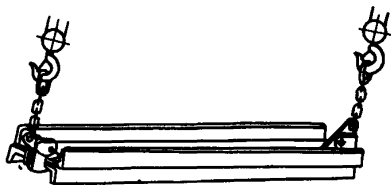
Рис. 5. Строповка швеллера захватами
