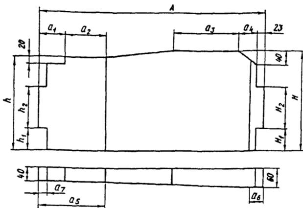
Рис. 5. Профилированные лопатки конструкции Дальзнерго
