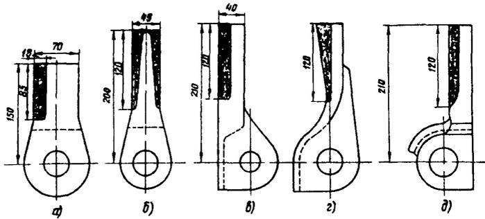
**Рис. 4. Основные конструкции бил, применяемых для молотковых мельниц:**
