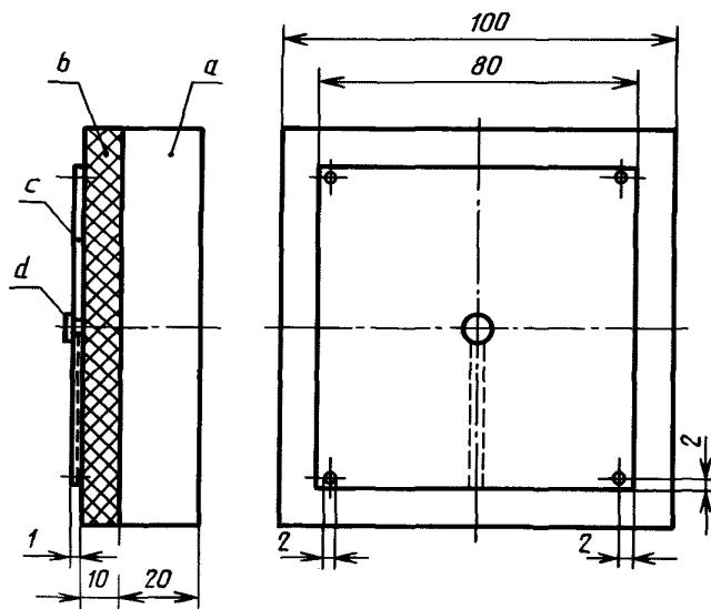
*a* — квадратная пластина из твердой древесины; *b* — материал тепловой изоляции: этот материал не должен быть сжат между медной пластиной и пластиной из твердой древесины; *c* — квадратная медная пластина; *d* — термопары, укрепленные в центре медной пластины; проволока термопары пропущена между медной пластиной и материалом тепловой изоляции
