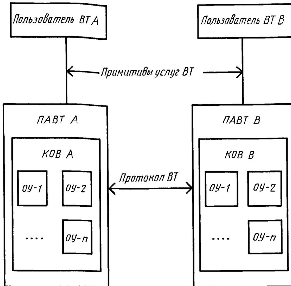
Рисунок 2 — Объекты управления в модели протокола ВТ
