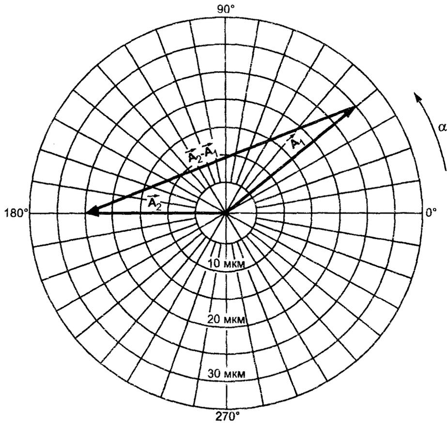
исходный вектор —  $|\vec{A}_1| = 30 \text{ мкм}$ ,  $\alpha = 40^\circ$ ; вектор после изменений —  $|\vec{A}_2| = 25 \text{ мкм}$ ,  $\alpha = 180^\circ$ ; изменение амплитуды вибрации —  $|\vec{A}_2| - |\vec{A}_1| = -5 \text{ мкм}$ ; амплитуда вектора изменения вибрации —  $|\vec{A}_2 - \vec{A}_1| = 52 \text{ мкм}$
