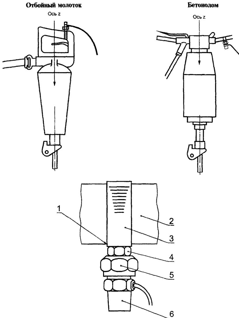
1 — площадка с отфрезерованной поверхностью; 2 — рукоятка; 3 — обжимной хомут;
