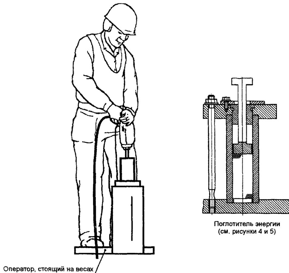
Рисунок 3 — Рабочее положение оператора при испытаниях отбойного молотка
