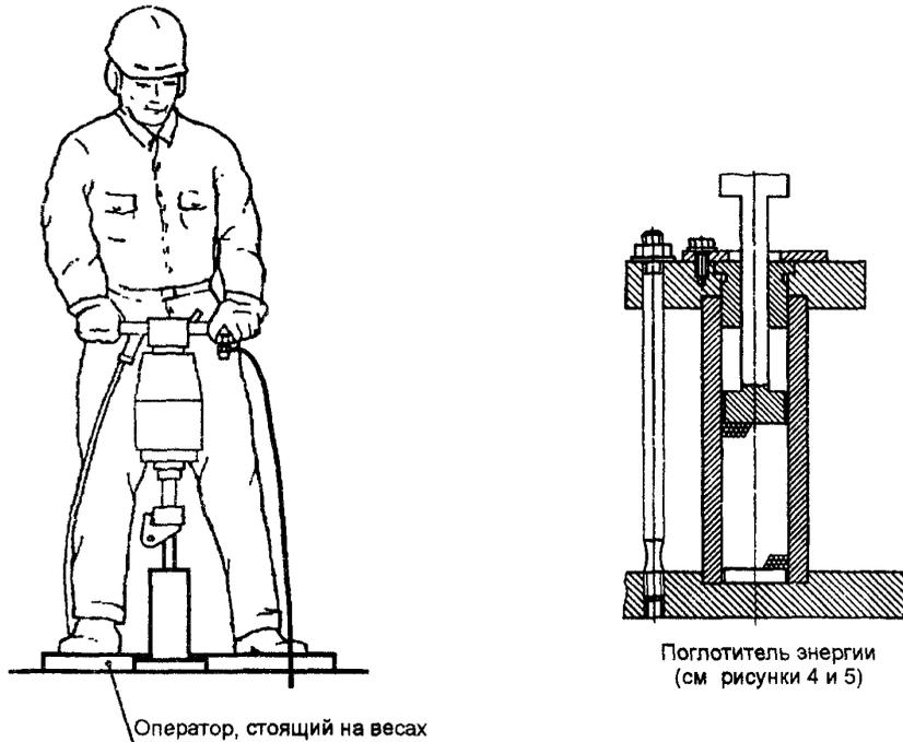
Рисунок 2 — Рабочее положение оператора при испытаниях бетонолома
