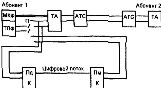
МКФ — микрофон микротелефонной трубки телефона аппарата; ТЛФ — телефон микротелефонной трубки телефона аппарата; П — переключатель; ТА — телефонный аппарат; АТС — автоматическая телефонная станция; Пд К — передающая часть оцениваемого кодека; Пм К — приемная часть оцениваемого кодека.
