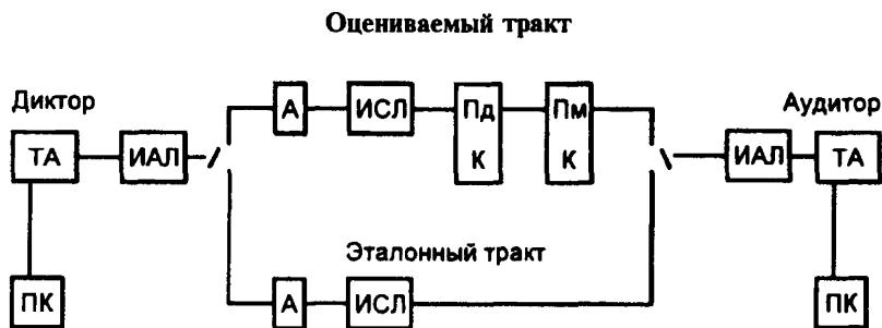
ТА — телефонный аппарат; ИАЛ — искусственная абонентская линия; ПК — питающий комплект; А — аттенюатор; ИСЛ — искусственная соединительная линия; Пд К — передающая часть оцениваемого кодека; Пм К — приемная часть оцениваемого кодека.
