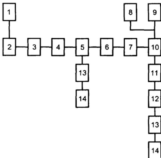
1 — средство юстировки, 2 — лазер, 3 — модулятор, 4 — телескопическая трубка, 5 — фазовая пластина, 6 — поляризатор, 7 — диафрагма, 8 — источник питания элемента, 9 — вольтметр, 10 — элемент на столике, 11 — поляризатор-анализатор, 12 — ослабитель, 13 — приемник, 14 — регистрирующее устройство
