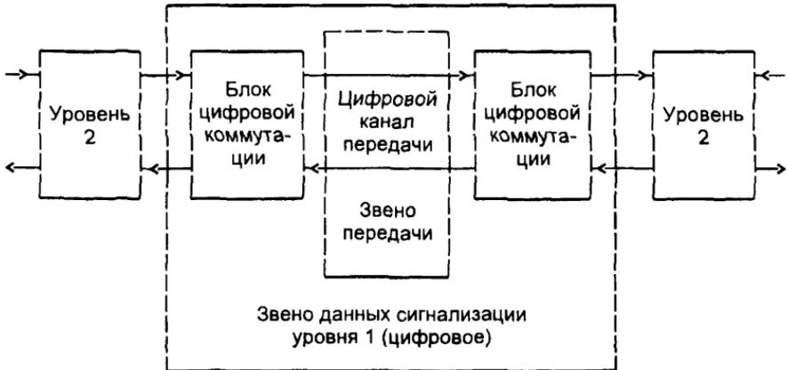
Рисунок 7.1 — Функциональная конфигурация звена данных сигнализации
