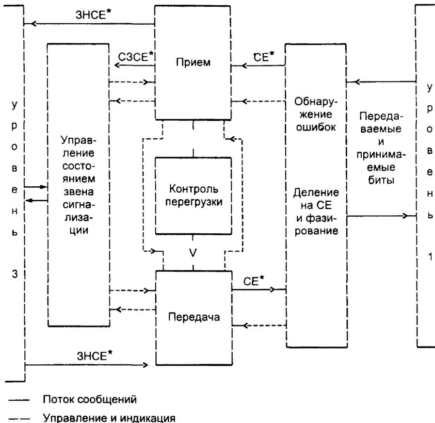
Рисунок 8.1 — Функциональная схема взаимодействия блоков звена сигнализации
