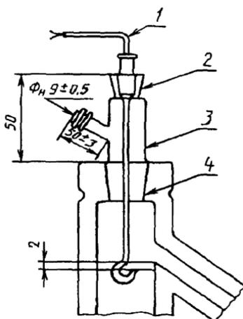
1 — термопара, 2 — конус 14/20, 3 — переходная муфта 4 — конус 19/38
