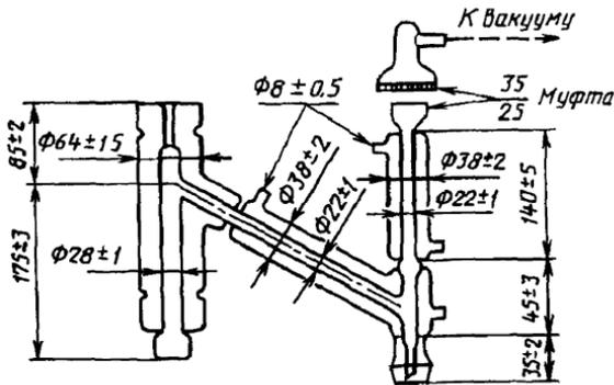
Рисунок 3 — Колонка с вакуумной рубашкой
