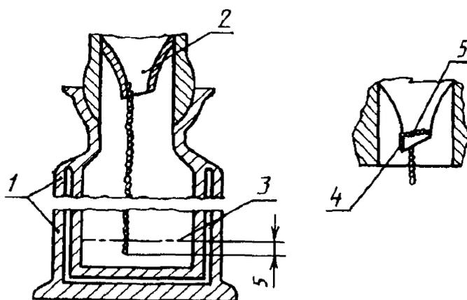
1 — приемник, 2 — конденсаторная трубка, 3 — отметка уровня  $10 \text{ см}^3$  отгона, 4 — крючок, 5 — пружина
