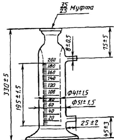
Рисунок 5 — Приемник
