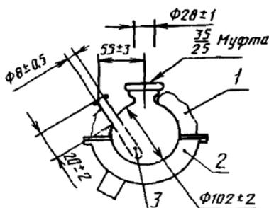
1 — теплоизоляционный материал, 2 — нагреватель, 3 — карман термопары
