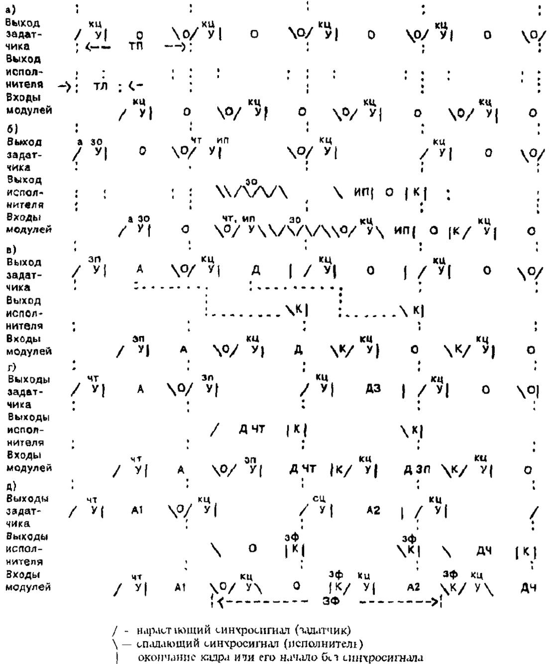
а) свободная магистраль б) цикл арбитража приоритетов з0 в) единичный цикл записи данных г) единичный цикл чтения данных д) цикл чтения данных с задержкой фазы передачи
