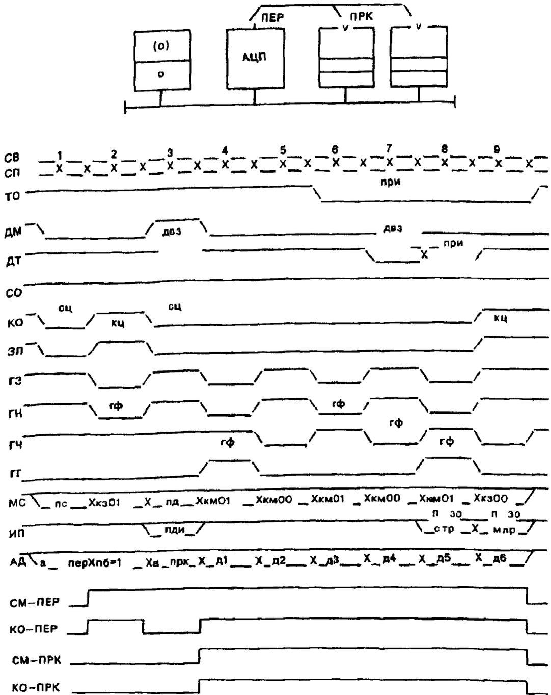
Рисунок Б.7 — Временные диаграммы сигналов в двухадресном групповом цикле передачи с раслоением памяти, в течение которого также проходит арбитраж 30
