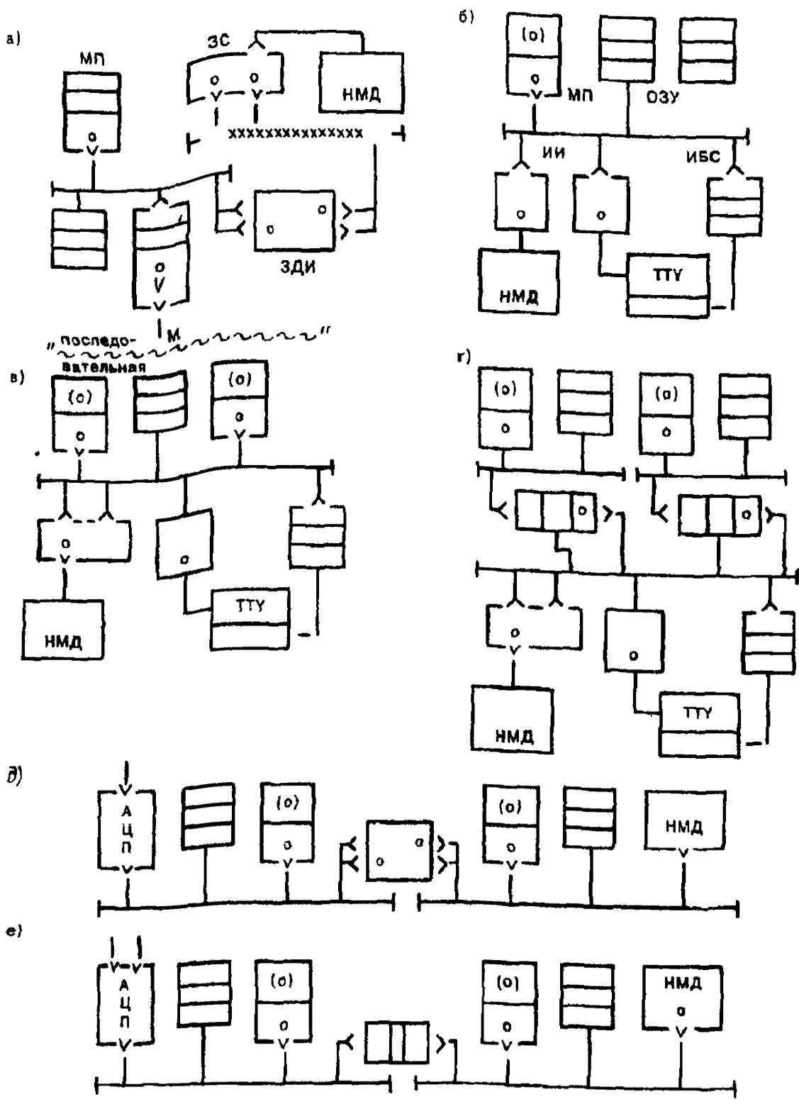
а) одноплатая микроЭВМ, подключенная через кабельную магистраль МСИ к НМД; б) персональная ЭВМ, ТТУ; в) двухпроцессорная микроЭВМ; г) вычислительная система с локальными подсистемами обработки данных; д) связь двух микроЭВМ через ЗДИ (прямой доступ в память); е) связь двух микроЭВМ через ИС (общее ОЗУ)
