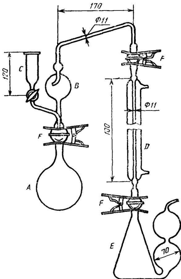
*A* — колба для дистилляции, *B* — каплеотбойная головка, *C* — капельная цилиндрическая воронка, *D* — холодильник, *E* — коническая колба с боковыми шарообразными расширениями, *F* — пружинные зажимы
