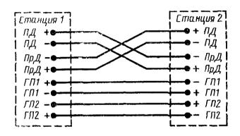
ПД — передаваемые данные ПрД — принимаемые данные ГП1 — готовность к приему станции 1 ГП2 — готовность к приему станции 2
