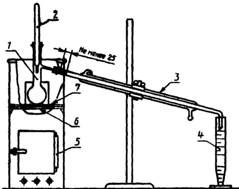
1 — дистилляционная колба (п. 4.1.1); 2 — термометр (п. 4.1.2); 3 — холодильник (п. 4.1.4); 4 — приемник (п. 4.1.3); 5 — защитный кожух (п. 4.1.5); 6 — огнеупорная прокладка, 7 — огнеупорная прокладка (п. 4.1.6)
