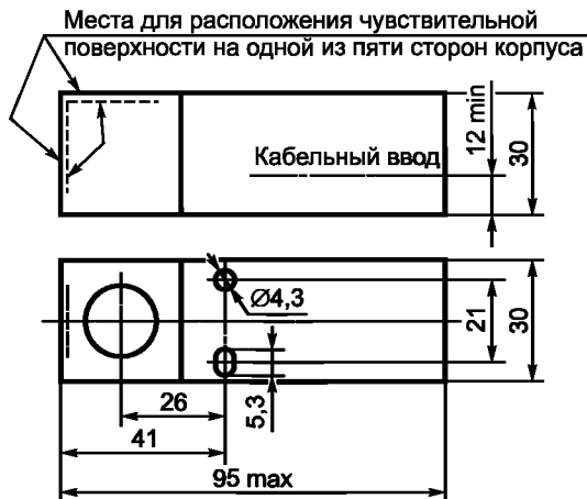
Рисунок А.1 (СС) а — Габаритные размеры датчика типа С30
