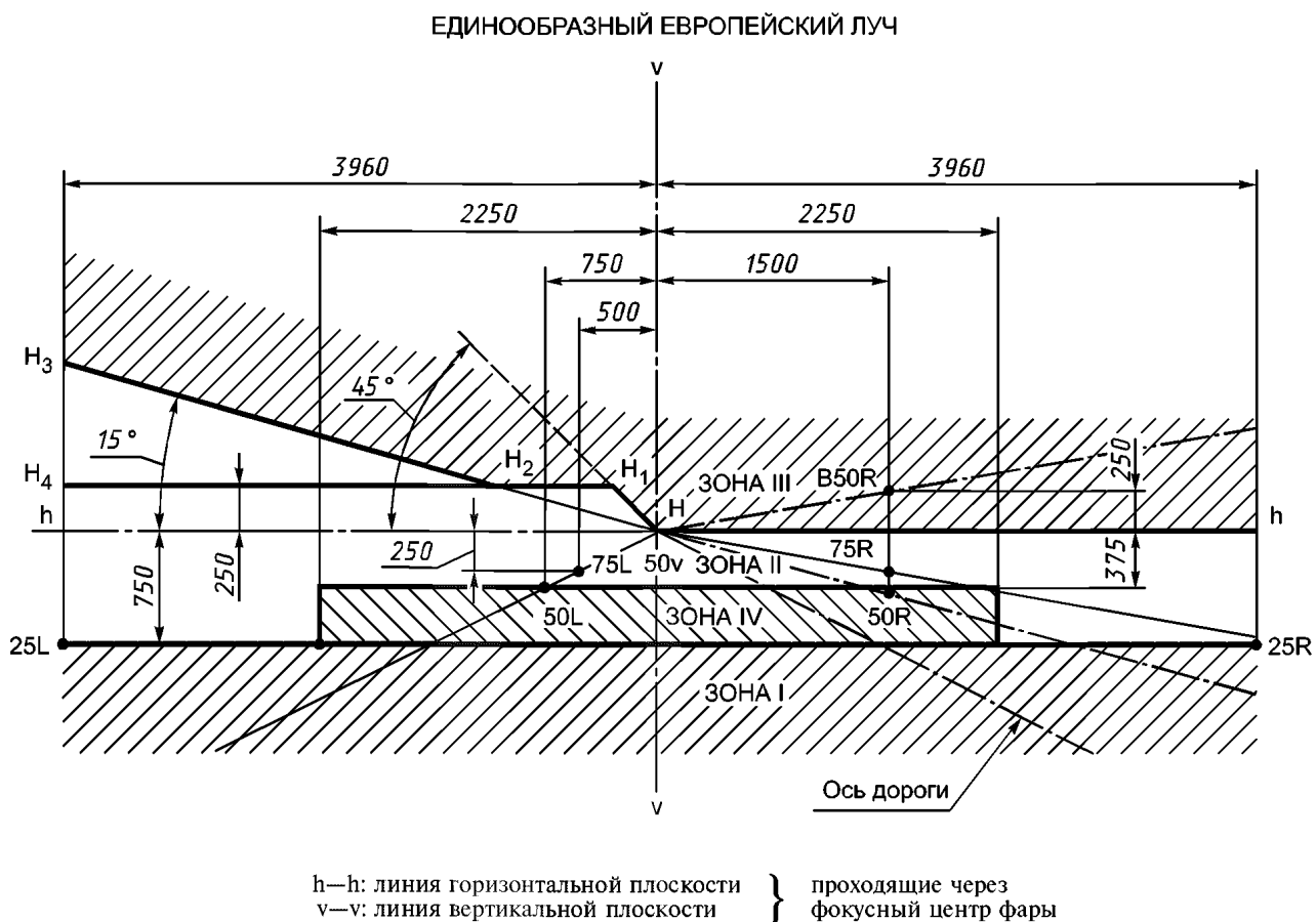
Рисунок В — Фара для левостороннего движения
