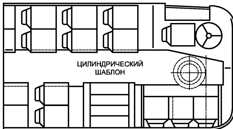
Рисунок 3.11В (см. 5.7.5.3.2) — Сиденья установлены под прямым углом к направлению движения
