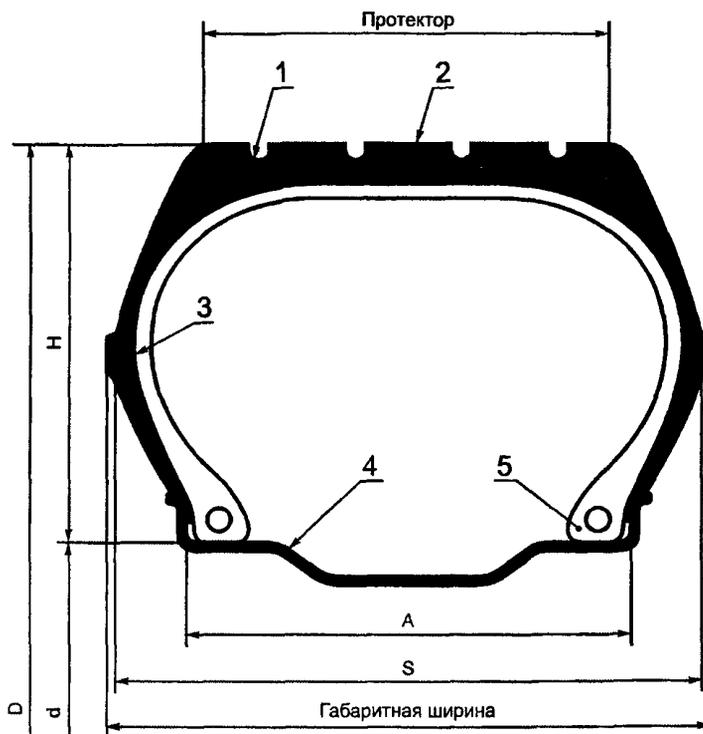
$D$  — наружный диаметр;  $d$  — номинальный диаметр обода;  $H$  — высота профиля;  $A$  — ширина обода;  $s$  — ширина профиля; 1 — канавка; 2 — ребро/грунтозацеп; 3 — каркас; 4 — обод; 5 — борт
