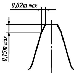
1. При изготовлении зубчатых колес допускается срез или закругление кромок вершин зубьев по высоте не более  $0,15 m$  и глубине не более  $0,02 m$  (см. чертеж).
