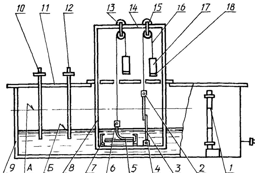
1—уровнемер, 2, 6—верхний зажим для образца, 3, 5—образец, 4, 7—нижний зажим для образца, 8—каркас, 9—камера для испытаний, 10—электроконтактный термометр, 11—крышка, 12—стеклянный термометр, 13—каретка, 14—направляющая каркаса, 15—ролик, 16—металлический трос, 17—груз, 18—платформа для груза, А—уровень жидкости по методу А, Б—уровень жидкости по методу Б
