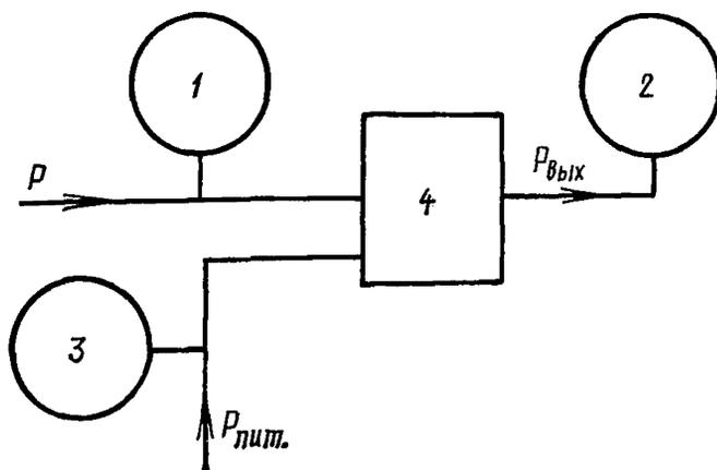
1—образцовый прибор для задания (измерения) избыточного давления 2—образцовый прибор для измерения (задания) выходного сигнала, 3—образцовый прибор для контроля за давлением воздуха питания, 4—поверяемый прибор
