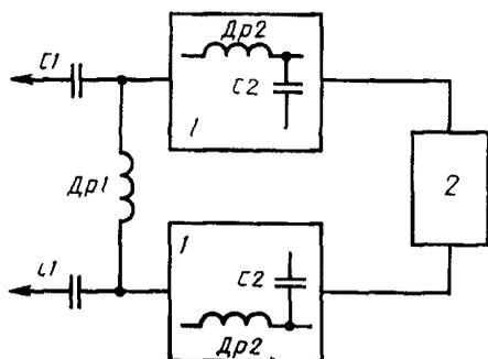
1 — раздельные схемы 2 — источник тока Др1 — измеряемый дроссель индуктивностью  $L_{и}$  C1 — защитный конденсатор емкостью не менее 100 мкФ Др2 — дроссель раздельной схемы индуктивностью не менее  $6 L_{и}$  C2 — конденсатор раздельной схемы емкостью не менее 10 мкФ
