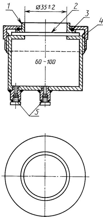
1 — зажимное приспособление для образца; 2 — образец; 3 — шариковый подшипник;
