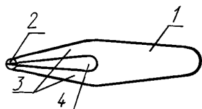
1 — тело пера; 2 — упрочнитель; 3 — половинка пишущего конца; 4 — расщеп пера
