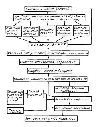
4.6. Поверхности деталей, не предназначенные к напылению, должны быть защищены экранами или накладками, а отверстия изолированы винтами или заглушками от воздействия абразивного материала при подготовке поверхности струйно-абразивным методом и от напыления.
