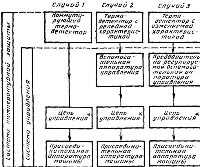
\* В случае температурной защиты с двумя уровнями цепь управления управляет также устройством сигнализации для первого уровня.
