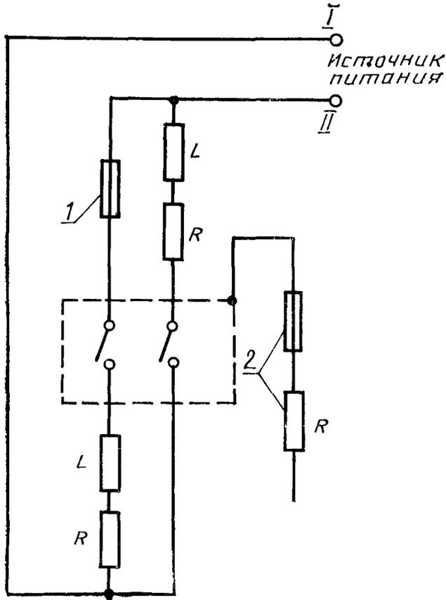
1 — предохранитель, 2 — предохранитель и сопротивление, установленные в соответствии с требованиями стандарта МЭК 158—1
