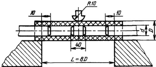
По середине и по концам образца вставляют металлические цилиндрические оправки.
